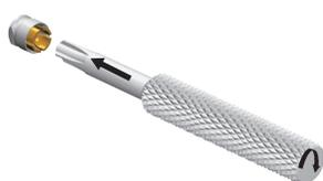
Per l'attivazione, la disattivazione e il disinserimento della ghiera ritentiva a lamelle è necessario usare il cacciavite / attivatore (N° cat. 072609). Inserire lo strumento a quattro camme nella sua posizione spingendolo a fine corsa sulla ghiera ritentiva a lamelle.
